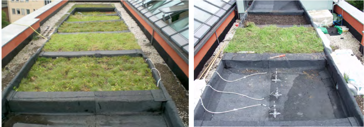
Abb. 3.3-11: Die Versuchsfelder auf dem ZUB Gebäude, rechts die Messfühler
