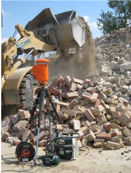
Bild 3 Messeinrichtung bei der Bauschutttaufnahme
